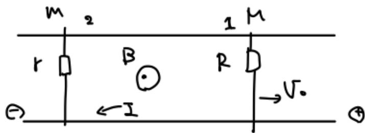
レールは十分長く、摩擦、空気抵抗、閉回路のインダクタンスは無視する。場全体に裏から表へ磁場  $B$  が貫いていくとし、時刻  $t=0$  に導体棒 1 に初速度  $v_0$  を与える。
